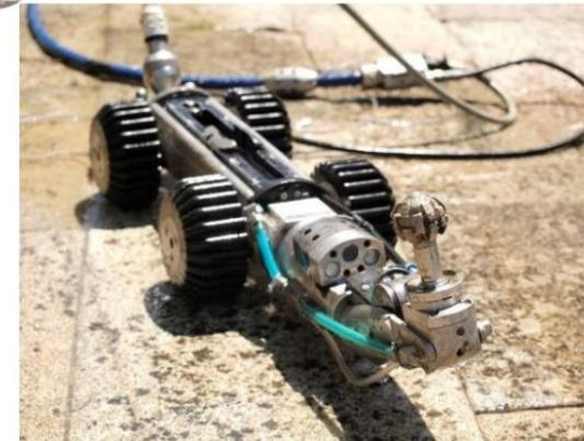
En el caso de que, tras la inspección, se detectaran obstáculos que impedirían el normal desarrollo de la extensión de la manga como conexiones de acometidas, sedimentos prominentes, raíces, etc., deberán ser eliminados mediante procedimientos de fresado y/o demolición con el fin de eliminar cualquier tipo de obstáculo y resaltes para el posterior montaje sin problema alguno de la manga.
