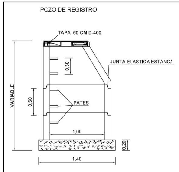
DETALLE DE POZO DE REGISTRO DE ANILLOS PREFABRICADOS Ø 1 M
