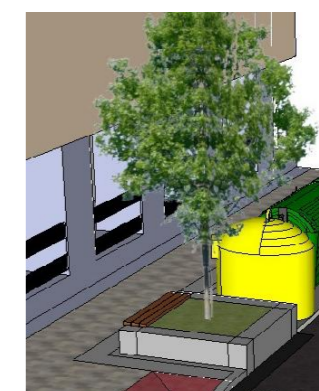
DETALLE ALCORQUE DE GRANITO CON ASIENTO EN MADERA
