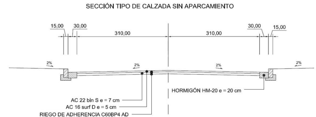
Tanto en la ejecución del pavimento de aceras como en la reposición del pavimento del vial, es preciso situar en la cota definitiva las tapas de las arquetas y/o pozos existentes.
